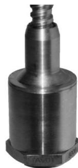
Электрическая изоляция пьезоэлемента и встроенного усилителя-преобразователя от корпуса исключает влияние на результаты измерений заземляющих контурных токов. Максимальная частота может снижаться при использовании кабелей повышенной длины.
