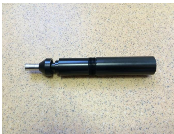
Рис.3г. Заключительный этап установки гермоколпачка: задвиньте гермоколпачок на корпус
