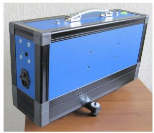
Молотки ударной машины активируются с помощью электромагнитов. Система управления электромагнитами обеспечивает выполнение требований по частоте и скорости падения молотков (см. «Технические характеристики»).
