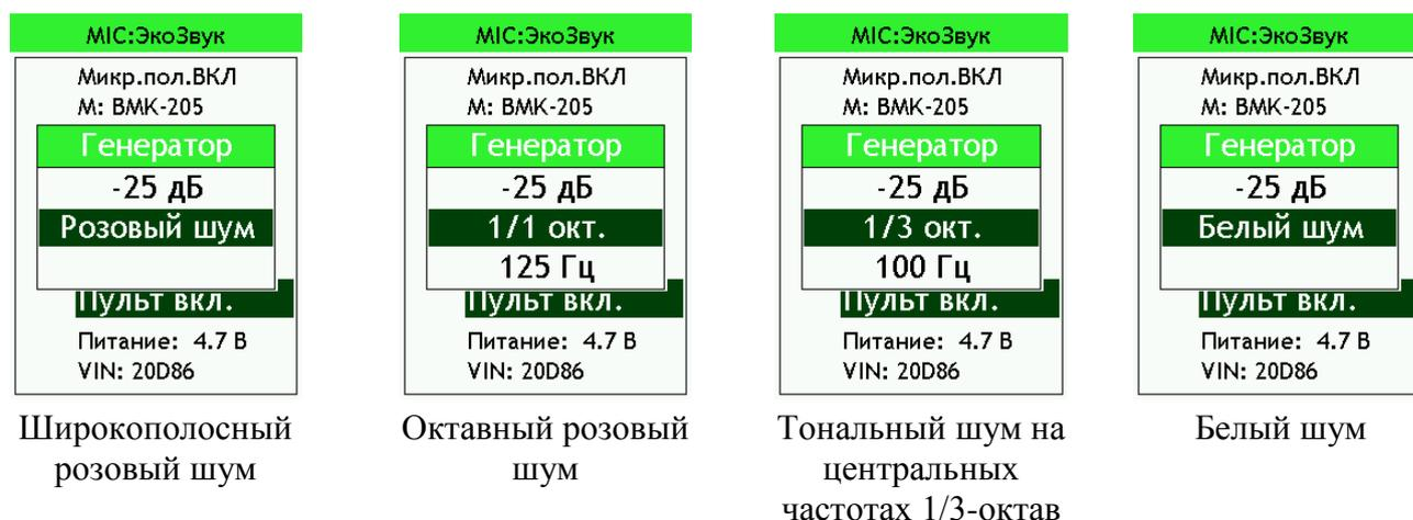
**Внимание.** В случае дистанционного управления доступен дополнительный режим генерации - розовый шум в 1/3-октавной полосе (от 100 Гц до 5000 Гц).
