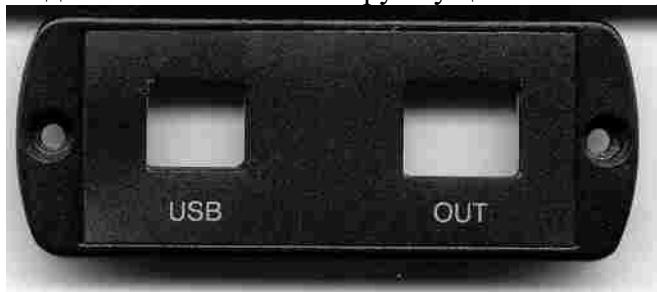
Порт USB предназначен для работы с файлами энергонезависимой памяти прибора, а порт OUT – цифровой выход – для работы с прибором в режиме телеметрии.
