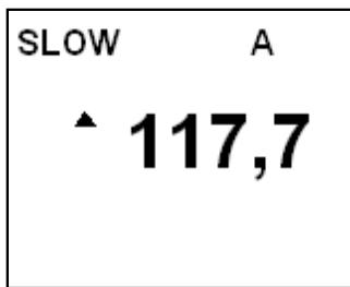
Если измеряемый сигнал слаб (измеряемые значения находятся вблизи нижней границы диапазона измерений), то нужно перейти в более низкий диапазон измерения прибора. В приборе предусмотрена индикация того, что уровень сигнала опустился ниже минимального предела измерения установленного диапазона. Эта индикация представлена в виде стрелочки «вниз» слева от текущего корректированного уровня звука:
