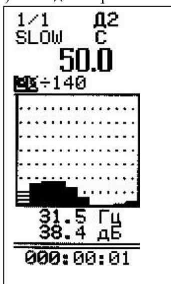
Если измерения не идут (то есть время в нижней строке не меняется), нажмите клавишу СТАРТ/СТОП. Если сигнал калибровки вызывает перегрузку (это может произойти, если калибровочный уровень превышает верхний предел установленного диапазона), выделите клавишей  $\uparrow$  обозначение «Д\_» в первой строке и установите нужный диапазон клавишами  $\leftarrow\rightarrow$ . При использовании калибраторов с уровнем звукового давления 94 дБ и 114 дБ калибровку рекомендуем производить в диапазоне Д2.
