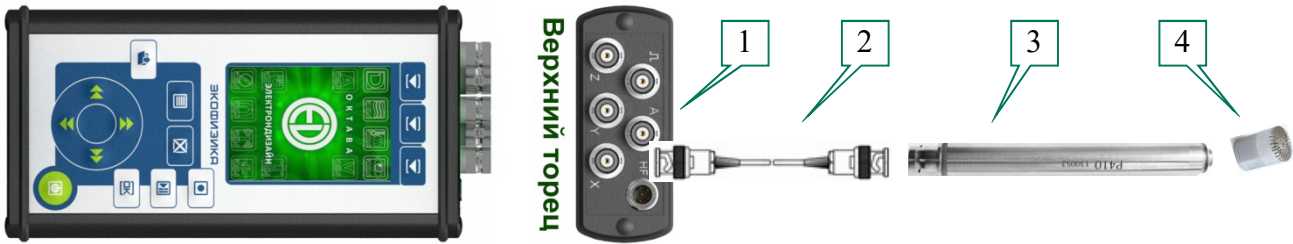
Схема 3. Подключение преполяризованных микрофонов ко входам А, Х, Y, Z
