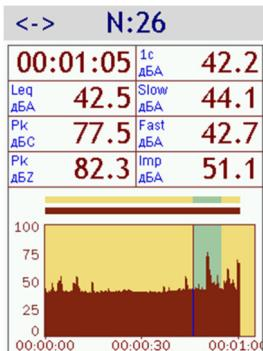
Если мультизапись короткая и вся хронограмма умещается на экране, то расположение горизонтальных полос, а также зона выделения на нижней полосе полностью совпадают с картинкой на графике (рисунок слева).
