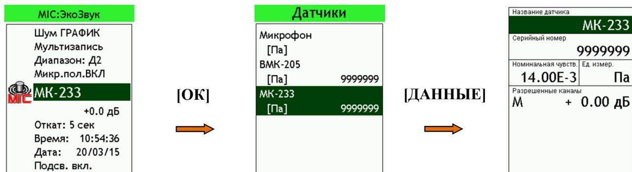
**Примечание.** При открытии карточки датчика из меню измерительной программы функции редактирования отключены. Вы можете только видеть калибровочные данные, но не изменять.
