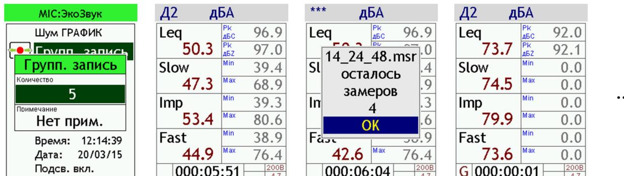
Если вы проводите измерения в режиме **Групповая запись**, клавиша [ЗАПИСЬ] будет доступна только в состоянии **СТОП**. При её нажатии появится информационное окно с именем файла и количеством оставшихся замеров (см. рисунок вверху). Затем прибор автоматически сбрасывает результаты и переходит в состояние ожидания следующего замера. Запуск нового измерения осуществляется клавишей [СТАРТ].
