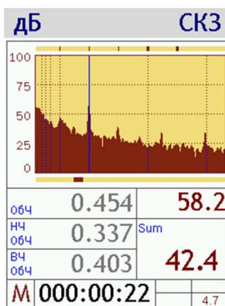
При открытии файла **Автозамера** мы попадаем на самый последний шаг записи. В левом нижнем углу экрана появляется символ **M**, который означает, что на экране представлены данные из памяти (memory) прибора. Справа от символа **M** указано, к какому моменту записи относятся эти данные.
