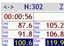
Для многоканальных измерительных режимов эта табличка выглядит так. В строках под отсчетом времени – данные для различных каналов, при этом курсором выделен канал, по которому построен график хронограммы.
