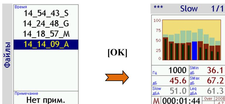
Файлы **Автозамера** маркируются окончанием **\_A**. Вызов сохраненных данных из памяти прибора и работа с ними рассмотрены подробно в п.7.11.3.
