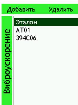
Находясь в меню-списке калибраторов, нажмите [**ЛКК**] [**Добавить**]. На экране появится карточка, заполненная данными датчика-образца.
