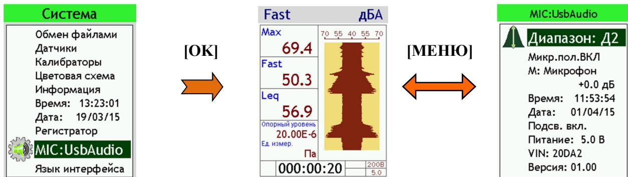
Эта программа превращает прибор в цифровой микрофон, который можно подключать к компьютеру как типовое устройство **USB Audio** и выполнять звукозапись стандартными средствами операционной системы и программами.
