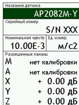
Находясь в меню-списке зарегистрированных датчиков, выберите клавишами [ВВЕРХ] и [ВНИЗ] тот датчик, который вы хотите использовать в качестве образца для новой карточки, и нажмите левую контекстную клавишу [Добавить]. На экране появится карточка, заполненная данными датчика-образца.
