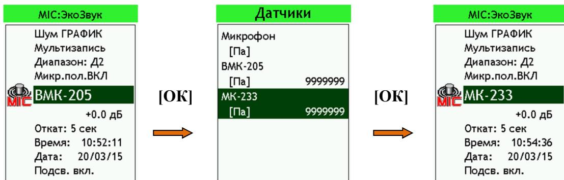
Выберите нужный датчик из списка клавишами [**ВНИЗ**] и [**ВВЕРХ**] и нажмите клавишу [**ОК**]. Выбранный датчик и его калибровочная поправка появятся в меню измерительной программы.
