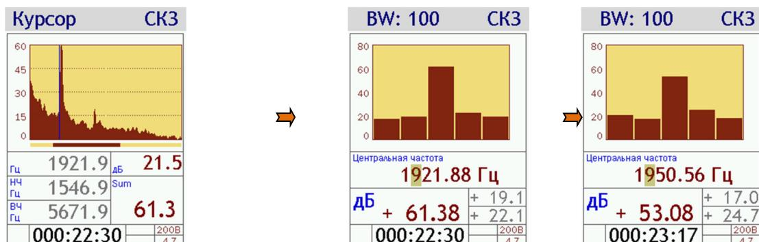
Установите в обзорном спектре частотный курсор примерно на тот пик, который вас интересует (клавишами [ВЛЕВО] и [ВПРАВО] или - для быстрого перемещения по спектру - одновременным нажатием клавиш [ДАННЫЕ] (удерживать)+[ВВЕРХ] или [ВНИЗ]). Затем нажмите одновременно [ДАННЫЕ]+[ОК].
