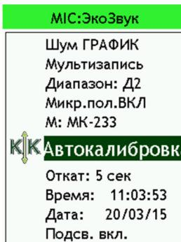
Для активации функции автокалибровки войдите в меню измерительной программы (см. пп.7.3, 7.4), выделите калибровочную поправку нужного канала и нажмите левую контекстную клавишу над экраном. Значения калибровочных поправок каждого датчика заменятся словом «**Автокалибровка**».
