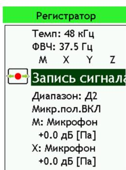
**Темп:** частота дискретизации (выборки). Возможные значения: 93,8 Гц; 187 Гц; 375 Гц; 750 Гц; 1.5кГц; 3кГц; 6кГц; 12кГц; 24кГц; 48кГц.
