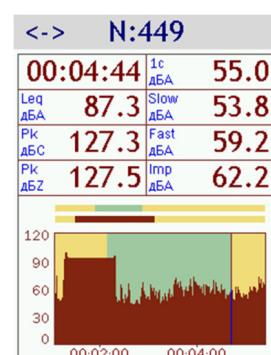
На графике в нижней части окна показано изменение во времени текущего уровня звука или вибрации. Зона обработки показана полосой светло-зелёного цвета (вертикальной для зоны обработки внутри выделенного участка - рисунок слева; и горизонтальной для зоны обработки по превышению порога – см. средний рисунок выше). При открытии файла выводится окно с зоной обработки внутри выделенного участка (с меткой **N:XX**), при этом вся мультизапись попадает в зону обработки.
