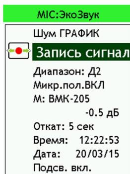
Если в меню измерительной программы выбрать тип сохранения данных **Запись сигнала**, то вы сможете одновременно с измерениями осуществлять запись временных реализаций сигналов. Характеристики записываемых сигналов (частотный диапазон, частота выборки и т.п.) могут быть разными для различных измерительных программ (см. раздел соответствующей измерительной программы).
