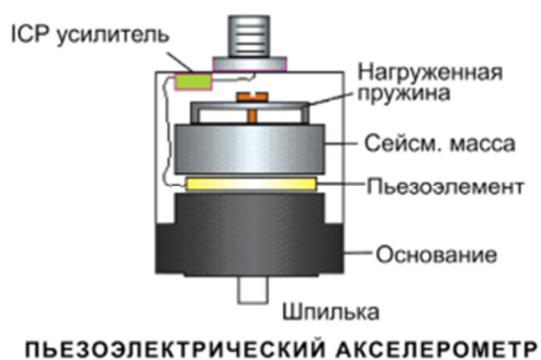
Пьезоакселерометры обладают уникальными преимуществами по сравнению с иными типами датчиков вибрации: широчайший динамический диапазон (до 180 дБ!), большой частотный диапазон при малых размерах и весе.
