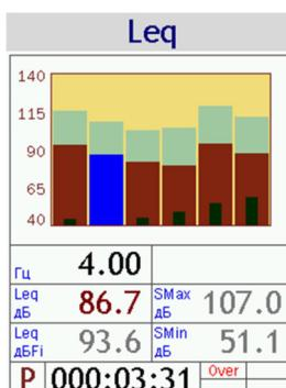
Эквивалентные, макс. и мин. УЗД в инфразвуковой области частот для зоны обработки
