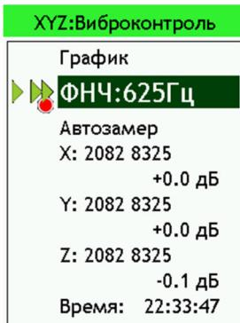
Пользователь может самостоятельно задать полосу частот, в которой будут измерены различные параметры виброскорения, скорости и перемещения. Чтобы выбрать верхнюю границу полосы пропускания, в меню измерительной программы выделите строку **ФНЧ** (фильтр низких частот) клавишами [ВВЕРХ], [ВНИЗ]. Воспользуйтесь клавишами [ВЛЕВО], [ВПРАВО], чтобы выбрать частоту среза **ФНЧ**: 625 Гц, 1.25 кГц, 2.5 кГц, 5 кГц, 10 кГц.
