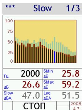
Результаты измерений, полученных путем постобработки сигналов, можно сохранить в память методом мультизаписи (длина мультизаписи назначается при этом прибором автоматически так, чтобы данные могли заполнить свободную память). Сохранение результатов осуществляется с помощью клавиши [ЗАПИСЬ].
