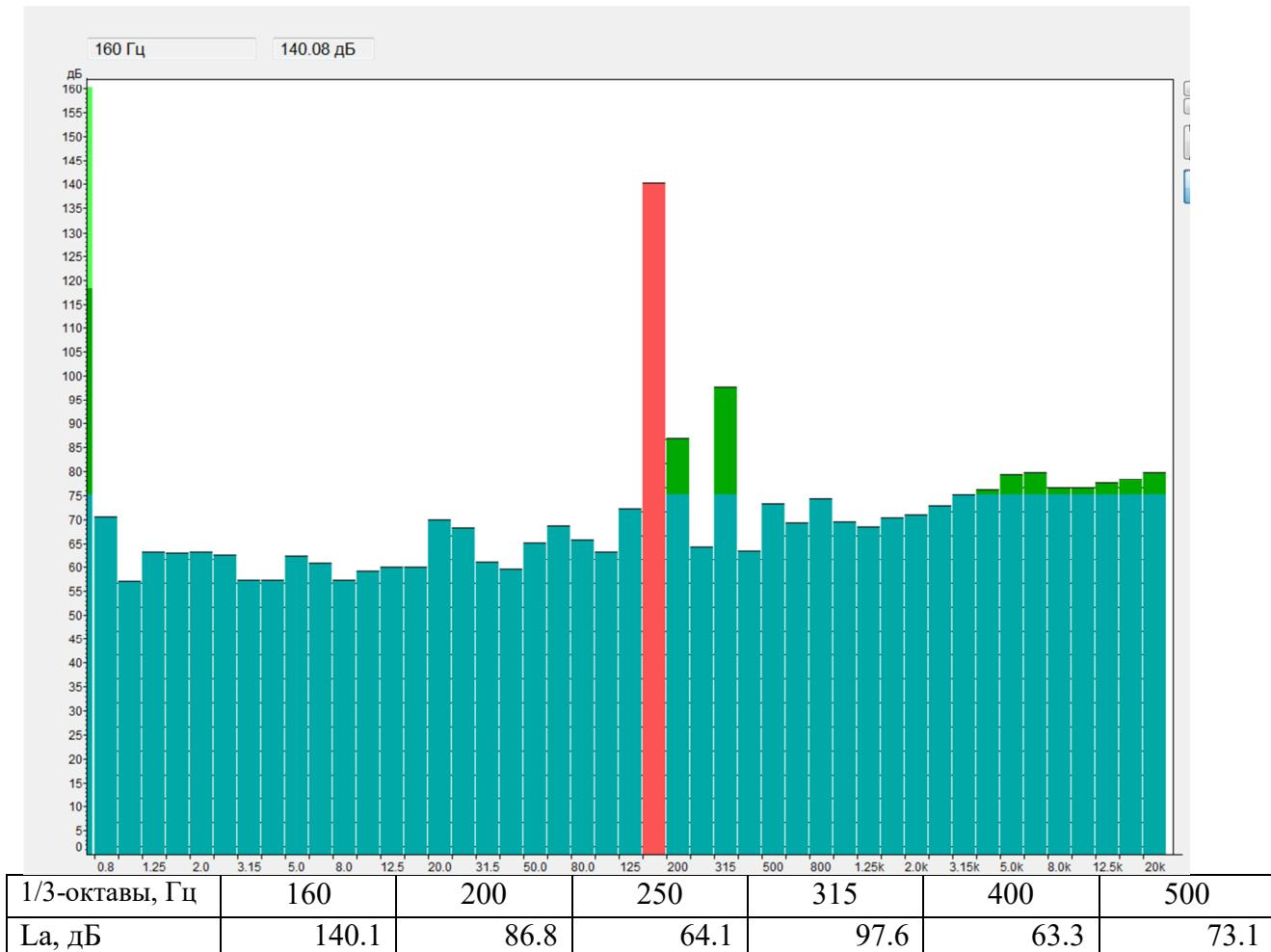
**График спектра 1/3-октавных уровней ускорения в дБ отн 1 мкм/с<sup>2</sup>**
