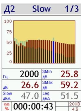
Когда воспроизведение сигнала заканчивается, проценты в левом нижнем углу исчезают, а рядом появляется слово **СТОП**. Если при этом вы проводили обработку сигнала (то есть запустили измерение клавишей [СТАРТ]), то на экране останутся результаты измерений.
