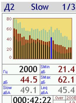
В окне результатов клавиша [СТАРТ/СТОП] запускает измерения. Повторное её нажатие переводит прибор в состояние ПАУЗА.
