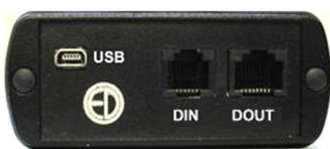
Порт **USB** предназначен для работы с файлами энергонезависимой памяти прибора, передачи результатов измерений в режиме реального времени (телеметрия) в компьютер по кабелю USB на короткие расстояния, а также для питания прибора от внешнего источника.
