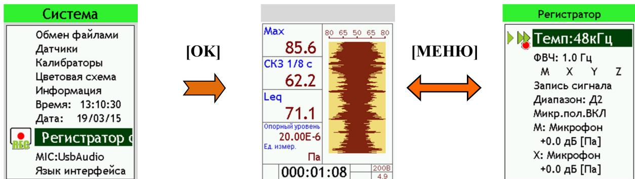
Эта программа позволяет осуществлять запись оцифрованных временных реализаций сигнала от входного канала в энергонезависимую память прибора, а также передавать эти реализации по телеметрии на внешние устройства.
