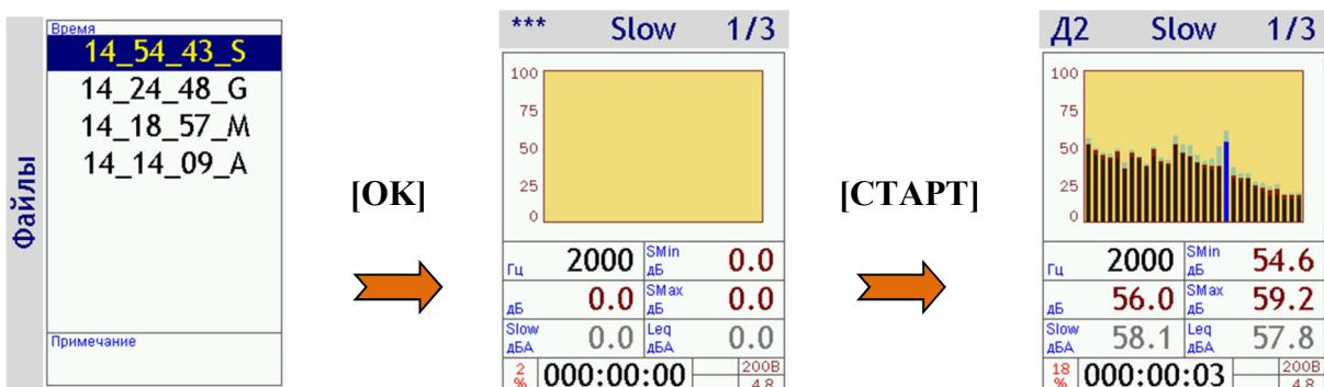
Вы увидите обычное окно измерений, в левом нижнем углу которого будут бежать проценты. Эти проценты означают, какая доля сигнала уже прошла обработку. Прибор может обрабатывать этот сигнал точно так же, как он обрабатывает сигналы, поступающие на его вход с датчиков. Запуск, остановка и сброс измерения осуществляются клавишами [СТАРТ/СТОП] и [СБРОС].
