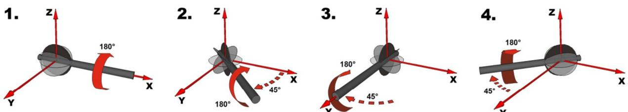
5. После завершения вращений по п.п.2–4 остановить измерение клавишей **СТОП** индикаторного блока. Записать значение максимальной напряженности ЭП или МП.
