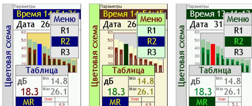
Клавиши **[ВЛЕВО]** и **[ВПРАВО]** переключают палитру цветов, которыми изображаются различные элементы экранного окна прибора. Клавиши **[ВВЕРХ]** и **[ВНИЗ]** регулируют яркость экрана.
