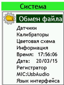
Для того чтобы открыть доступ к файлам прибора через USB порт, выделите в меню «**Система**» пункт «**Обмен файлами**» и нажмите клавишу **[OK]** (или клавишу **[ДАННЫЕ]** – прямо из **стартового окна** или любого пункта меню «**Система**»). Прибор превращается в обычную флешку и начинает восприниматься внешними устройствами как съемный диск. На экране появится информационное сообщение
