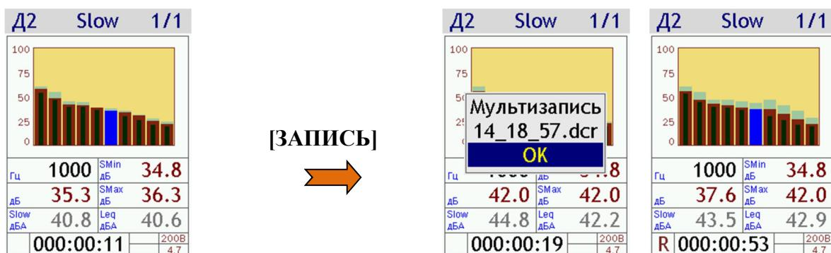
Сначала на экране на несколько секунд появится сообщение с именем файла, в который будет производиться запись. Файлы, получаемые в режиме **Мультизапись**, имеют расширение **.dcr**.
