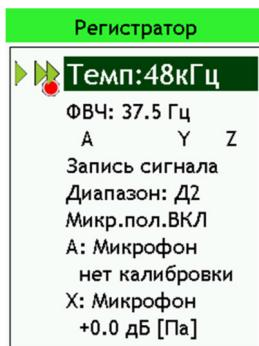
Чтобы сделать канал активным для выдачи телеметрии и записи в память, выделите клавишами со стрелками в третьей строке нужную позицию и нажмите клавишу **[OK]** (при выделении активные каналы выглядят так: **X**). Повторное нажатие клавиши **[OK]** сделает этот канал неактивным (при выделении неактивные каналы выглядят так: **X**).
