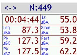
В табличке над хронограммой выведены параметры измерения для того шага мультизаписи, который отмечен на графике вертикальным курсором (в первой строке слева показан соответствующий отсчет времени).
