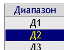
**Примечание 2.** **Д1** – наиболее грубый диапазон, предназначен для измерения высоких уровней; диапазон **Д2** может использоваться в подавляющем большинстве приложений; диапазон **Д3** используется при измерении слабых уровней.
