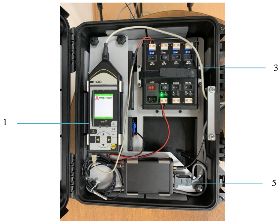
Рис. 2. Модификация система обеспечения автономных измерений ЭФ500-ENV из комплекса GPS-METEO
