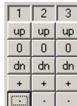
Кнопки **up** и **dn** смещают осциллограмму соответствующего канала вверх и вниз. Таким образом, можно развести осциллограммы разных сигналов.
