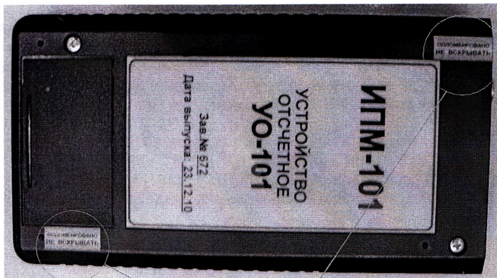
Рис.1 Общий вид измерителя напряженности поля ИМП-101
